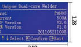
采用 240\*128 大尺寸点阵液晶显示器。主界面在显示焊机多种信息的同时，直接显示当前焊接功能的焊接参数，便于查看和修改。控制菜单则提供了更为方便的多种管理功能。
